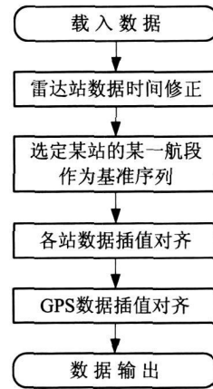
图 2 时间对准处理过程流程图
