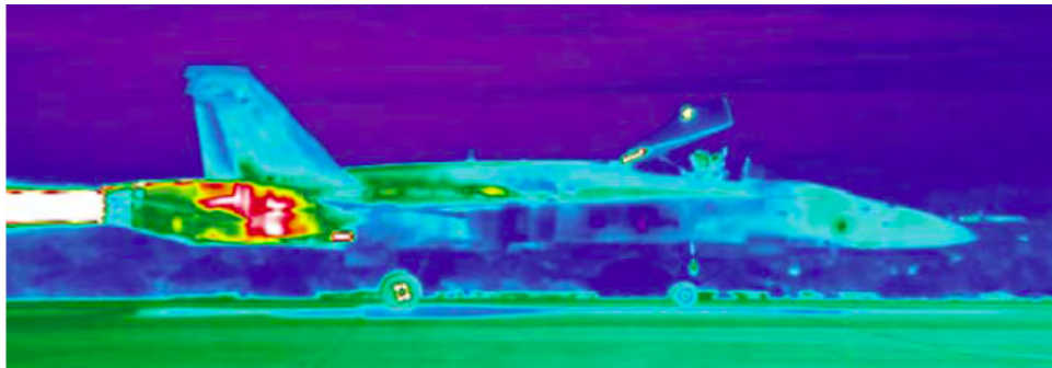
图 3 飞机尾焰红外辐射模型
