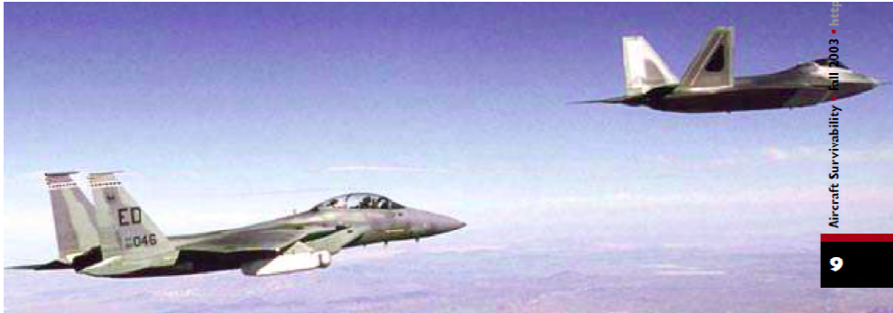
图 10 飞行中 F-22 的红外信号测试(从左到右为:挂载吊舱的 F-15B, F-22 测试机)
